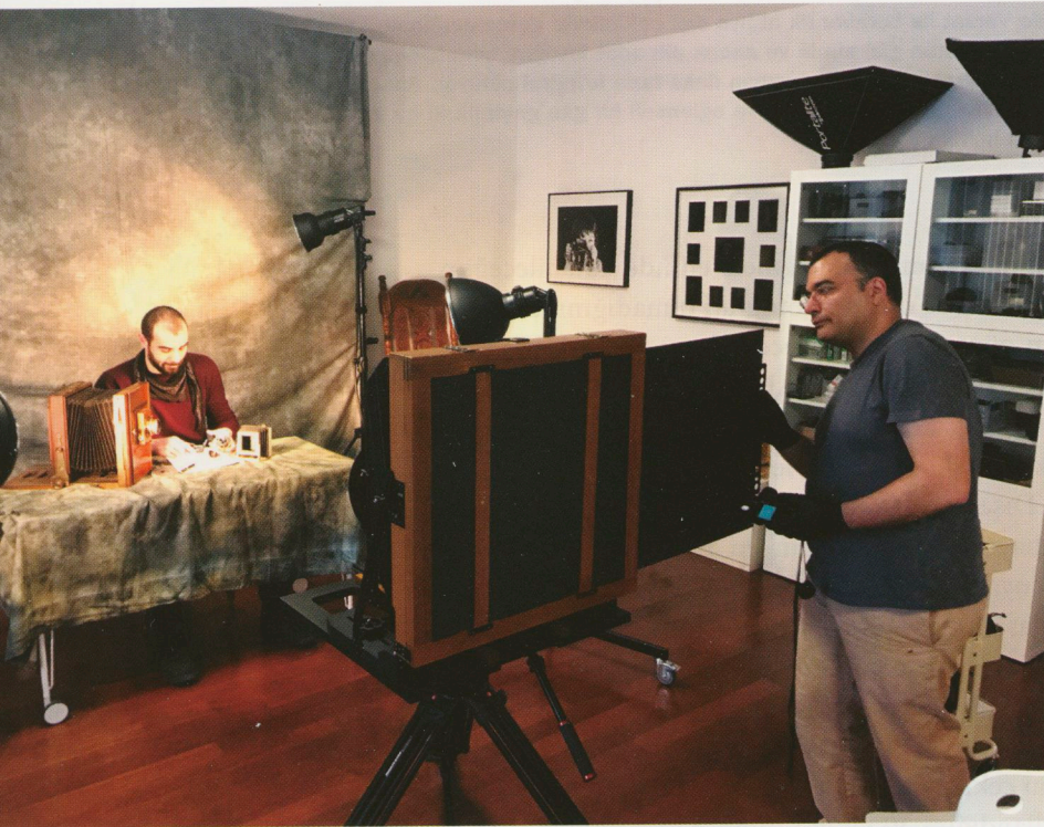
Islak plaka tekniği ile yapabileceğimiz fotoğrafın büyüklüğü, makinenin büyüklüğü ile orantılı. Bu fotoğraftaki makine ile 50x50 cm büyüklüğüne kadar fotoğraf yapmak mümkün.
